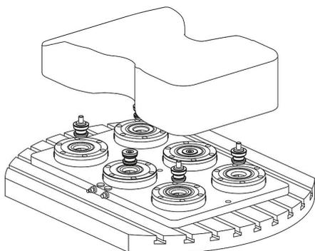
**UNILOCK bouchon de protection pour module de serrage**
