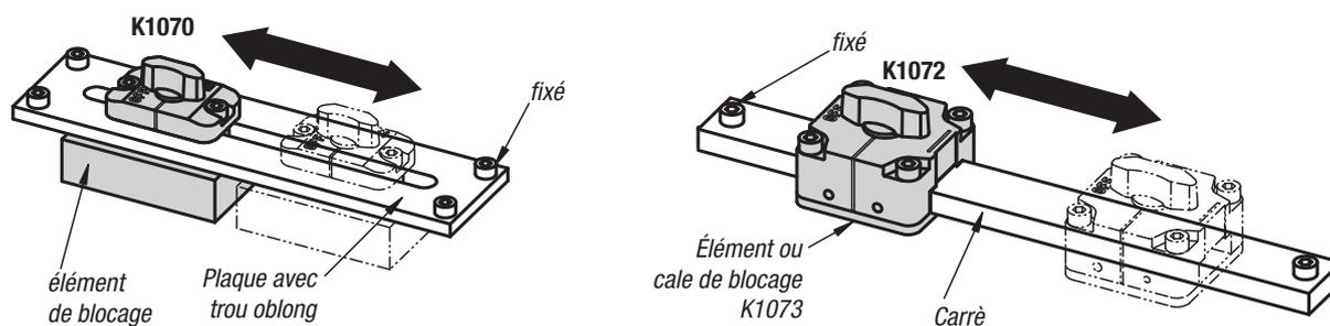
Plaques mobiles avec trou oblong ou carré - Verrou de serrage fixée avec élément de blocage
